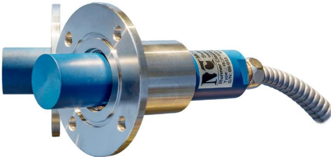
Der Wirbelstromsensor RCP-008/010 wird für berührungslose Messungen des Turbinenlaufradspiels von großen Francis- oder Kaplan-turbinen eingesetzt. Das Hochleistungs-Gehäusematerial ermöglicht eine dichte Montage der Wirbelstromsonde in den Turbinenhalsring oder in Turbinenlabirinth.
